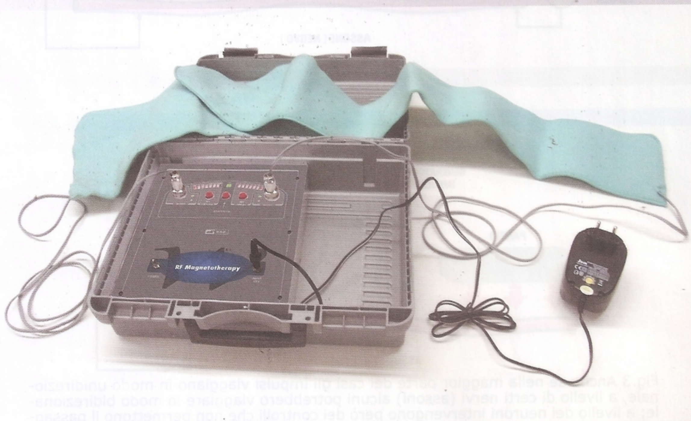
Fig.1 La scelta di inserire questa nuova Magnetoterapia RF in una valigetta 24 ore è legata all'idea di rendere portatile lo strumento corredato di tutto il necessario per eseguire la terapia, vale a dire diffusori e alimentatore.
