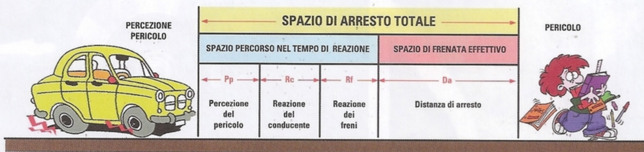
Fig.2 In questo disegno abbiamo schematizzato ciò che accade nel momento in cui il conducente di un veicolo ha percezione di un ostacolo sulla sua direttrice di marcia. Come noterete, lo spazio di arresto totale è dato dalla somma dello spazio percorso nel tempo di reazione e dello spazio di frenata effettivo.
